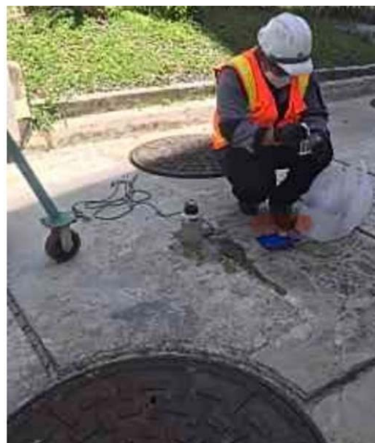
รูปที่ 2.2-31 การเก็บตัวอย่างน้ำเพื่อทำการวิเคราะห์คุณภาพน้ำทิ้ง
