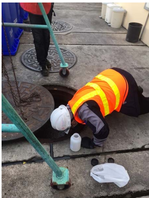
รูปที่ 2.2-31 การเก็บตัวอย่างน้ำเพื่อทำการวิเคราะห์คุณภาพน้ำทิ้ง
